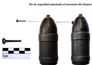
Figura 5. (Izquierda) Pin de seguridad y estopín; Figura 6. (Derecha) Imagen que muestra la ubicación del pin en el proyectil de 60 mm.
